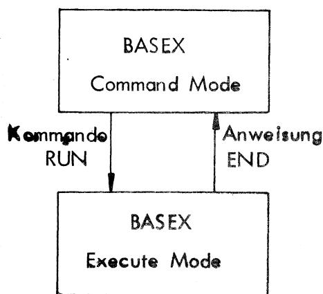
Im **Bedienungsbetrieb** nimmt das System Kommandos des **Bedieners** an, die sofort ausgeführt werden, und speichert Programm-Anweisungen, die später ausgeführt werden sollen.
