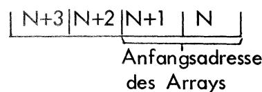
Die Parameter werden bei Aufruf der Systemprozedur durch das BASEX-Programm in die Register übergeben.
