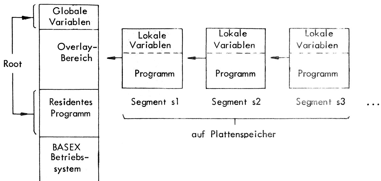
Alle Segmente und die Wurzel werden unter deren Namen zusammenhängend auf der Platte abgelegt und sind direkt vom DBOS her ausführbar.
