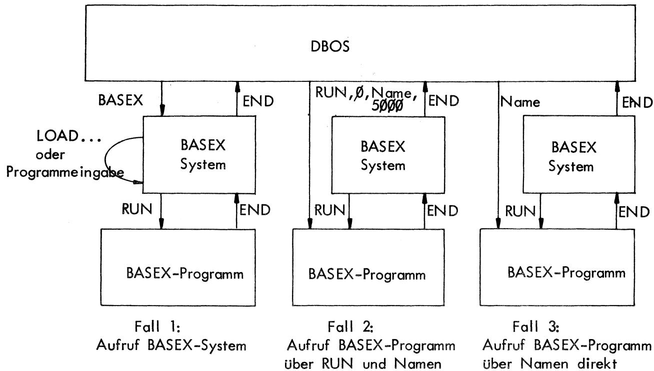
Fall 1: Der Bediener gibt BASEX ein. Der Interpreter wird geladen, und das System befindet sich im BASEX-Bedienungsbetrieb. Nun kann über das Kommando LOAD... ein vorhandenes BASEX-Quellprogramm geladen oder ein Programm eingegeben werden. Auch alle übrigen Möglichkeiten des BASEX-Bedienungsbetriebes bestehen.
