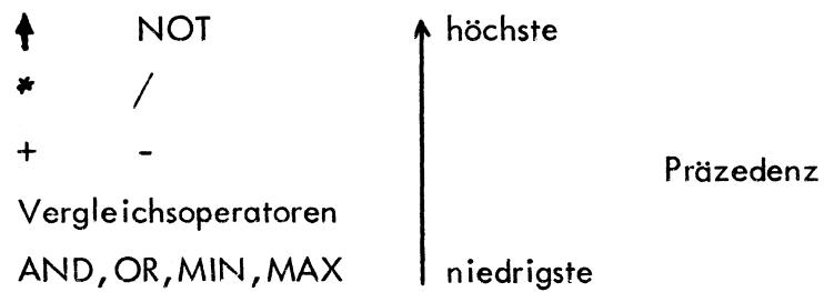
Befinden sich Stringvergleiche in einem Ausdruck, so haben die zugehörigen Vergleichsoperatoren die höchste Präzedenz.
