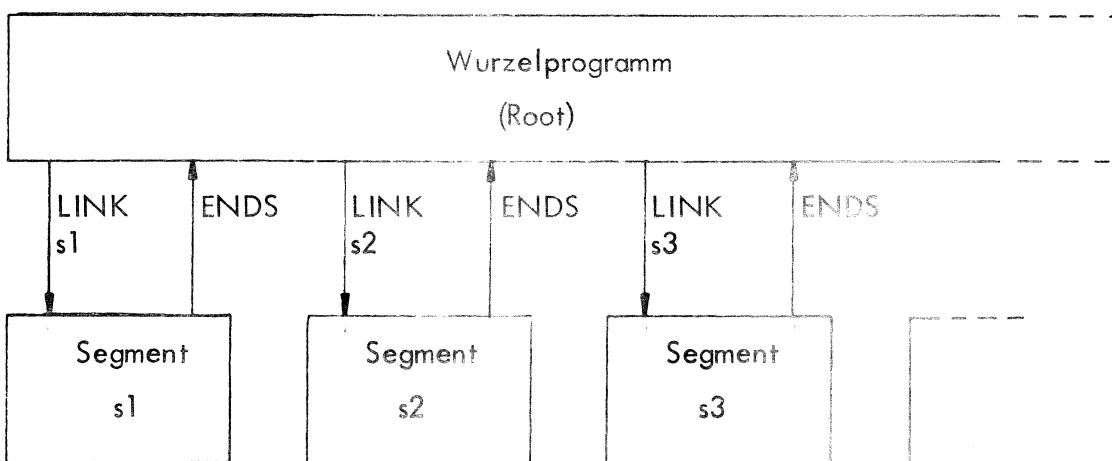
Jedes Segment wird durch einen Namen identifiziert (Buchstabe, u.U. gefolgt von bis zu 3 Buchstaben oder Ziffern). Es wird im Wurzelprogramm durch eine LINK-Anweisung mit Angabe des Namens aufgerufen; die Rückkehr aus dem Segment in die Wurzel bewirkt die ENDS-Anweisung.
