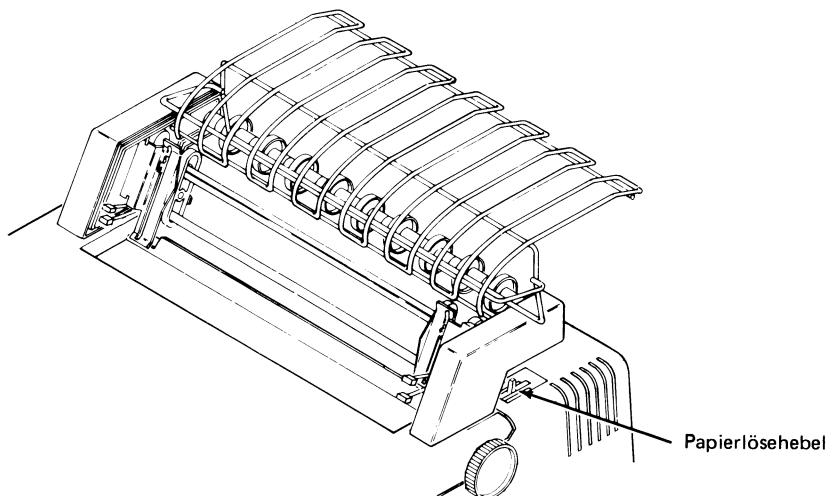
3. Stellen Sie sicher, daß der Drucker eingeschaltet und der Papierlösehebel zurückgestellt ist. (Wenn Sie den Papiertransport benutzen, stellen Sie sicher, daß das Papier dicht zwischen den Stiften und der Walze liegt.)
