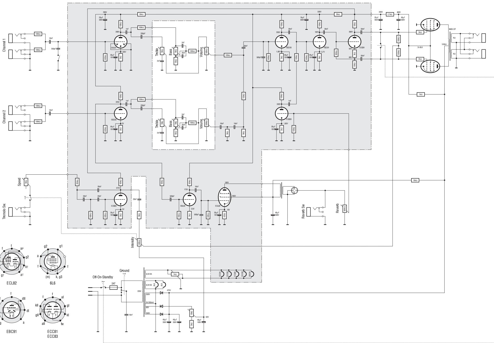
Guyatone GA-960, neu erfasst aus (wahrscheinlich modifizierter) Originalschaltung, 08/2011. Für Fehler übernehme ich keine Haftung. (Modifikation: reduzierte Siebung im Netzeil, andere Endröhren und Halbleitergleichrichter im Netzeil höchstwahrscheinlich original.)
