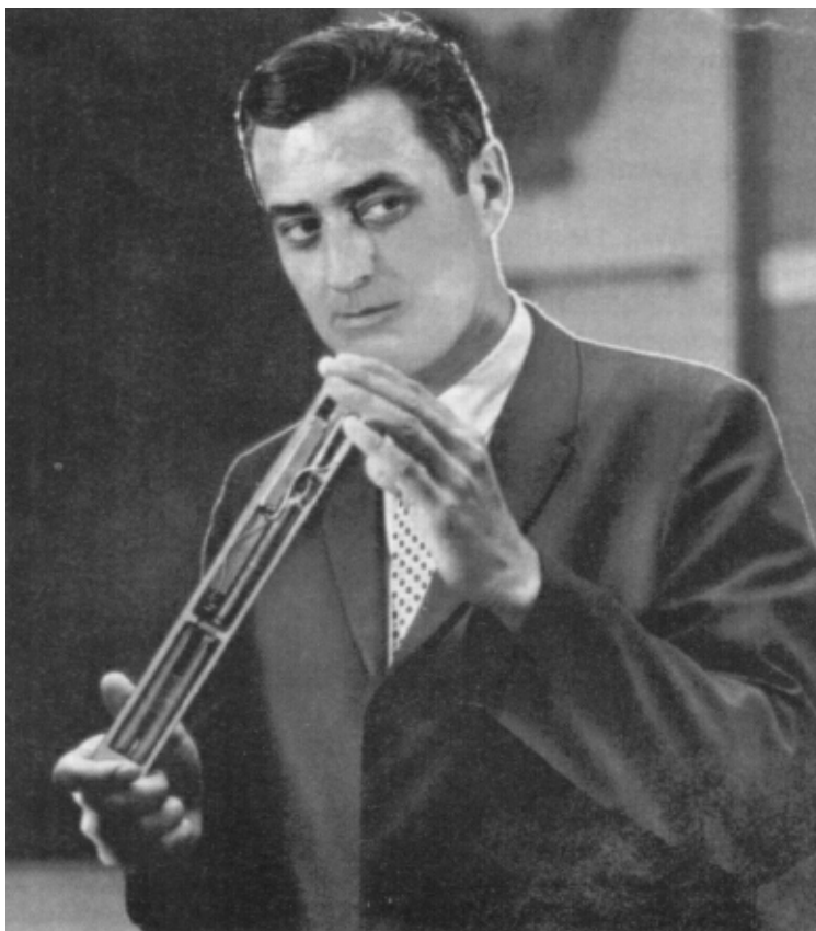
Bild 26: In Furnierholz eingebauter Mi- nispion hoher Lebensdauer aus dem Büro eines Staatssekretärs im US-Handels- ministerium
