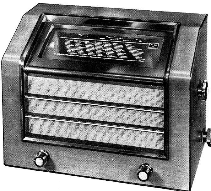
Knöpfe an der Vorderseite: links Rückkopplung, rechts Wellenschleuse;
