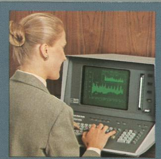
Grafik auf einer Speicherbildröhre bietet eine extrem hohe Auflösung und Genauigkeit und vermeidet unnötige Mengen von bedrucktem Papier. Zwei Schirmgrößen stehen zur Auswahl: 28 cm Diagonale im 4051 und 4052 und 48 cm Diagonale im 4054. Darüberhinaus kann der 4054 133 Zeichen pro Zeile und ein Fadenkreuz darstellen.
