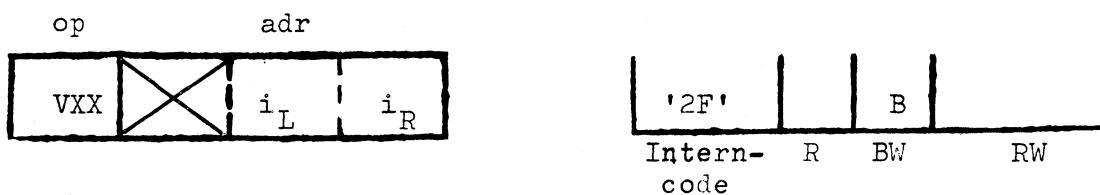
Wirkung:  $w1. \langle B \rangle, \langle i_R \rangle := \langle i_R \rangle - \langle i_L \rangle$
