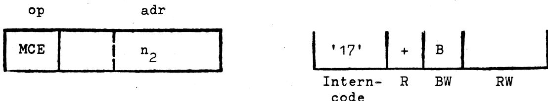
Wirkung: W1.  $mod2 := \langle \langle \dots \langle n_2 \rangle_2 \dots \rangle_2 \rangle + mod2$
