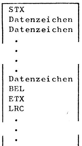
Anmerkung: Das Längsprüfzeichen LRC ergänzt die einzelnen Datenspuren auf gerade Parity.
