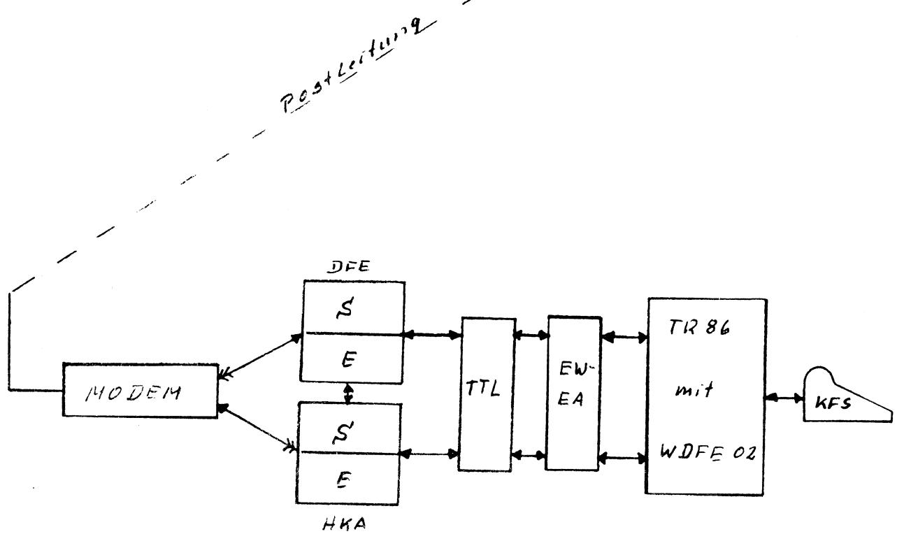
Abb. 2 Konfiguration Koppeln
