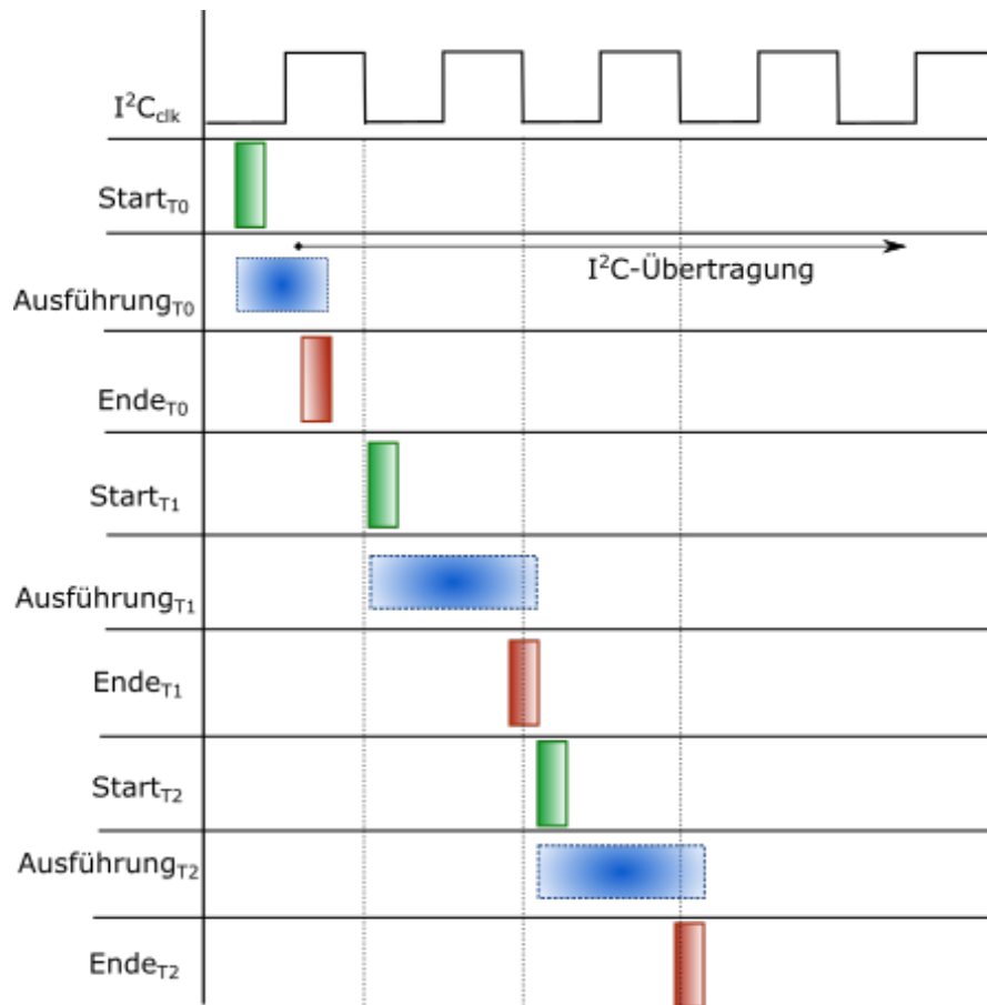
Abbildung 3.10: Abfolge von Ausführungen des extended Templates im Bezug zum Peripherietakt I^2C_{clk} .
