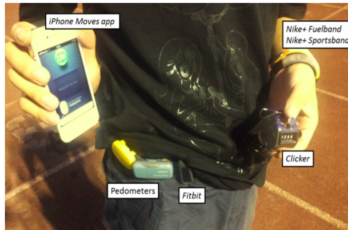
Abbildung 2.3.: Für die Studie wurden die Teilnehmer wie auf der Abbildung mit unterschiedlichen Activity-Trackern ausgestattet, um die Genauigkeit der Tracker zu ermitteln und diese untereinander zu vergleichen. Bildquelle: [GLKB13]
