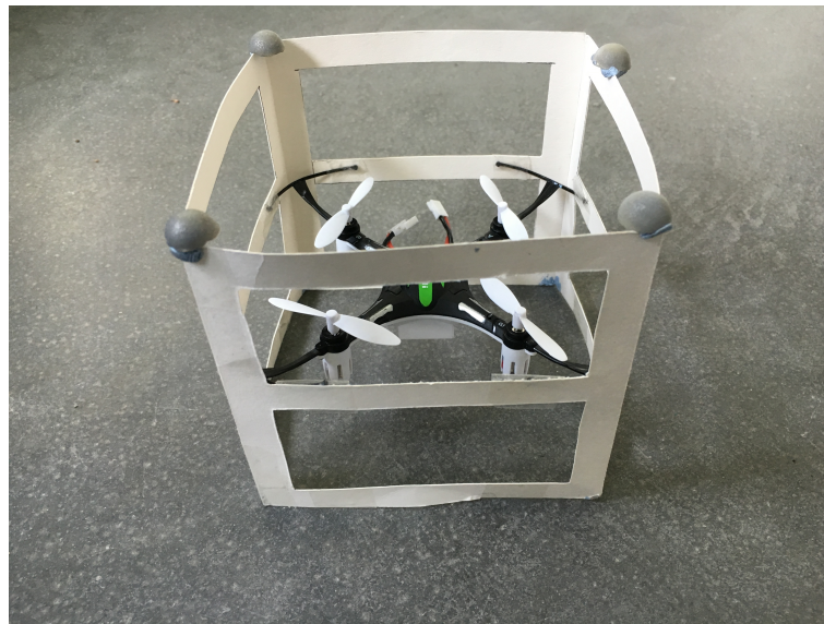
Abbildung 4.3: Hier sieht man die Konstruktion des Käfigs der Drohne.
