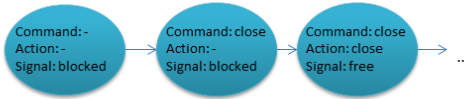
Abbildung 2.3: Visualisierung der LTL Formel G (\neg (Action=close) U (Signal=free))
