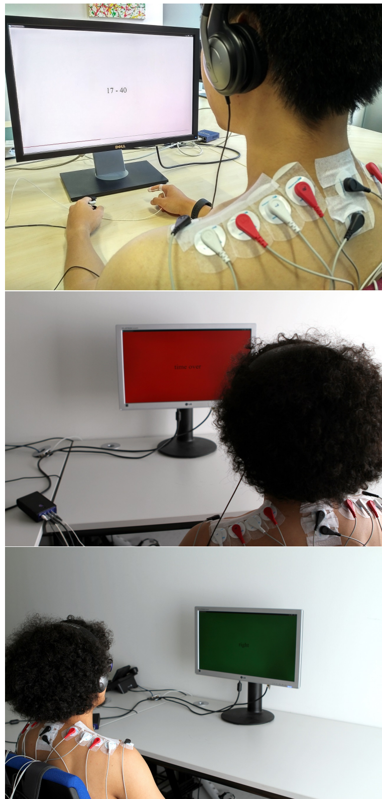
Abbildung 6.3.: Mental Arithmetic Test. Oben: Aufgabenstellung mit Timer im unteren Monitorbereich. Mitte: Ausgabe bei falschem Ergebnis oder abgelaufener Zeit. Unten: Ausgabe bei richtigem Ergebnis.
