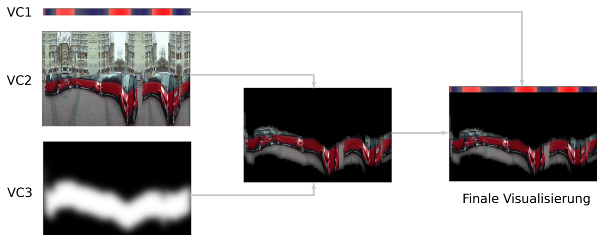
Abbildung 4.1: Die drei visuellen Komponenten der Slit-Scan-Visualisierungstechnik : Spektrogramm (VC1), Slit-Scan (VC2) sowie der Fokus-Map (VC3).
