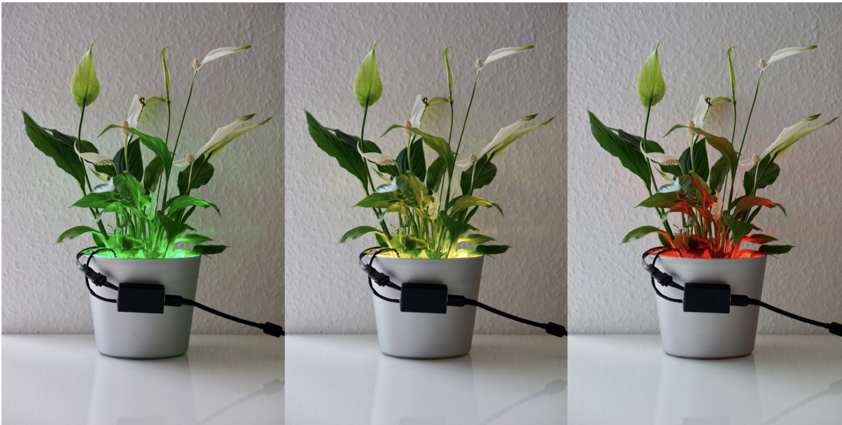
Abbildung 5.4.: Persistente Darstellung des Zustands an der Pflanze in den Farben Grün, Gelb und Rot durch die LEDs im Topf. Links: Die LEDs leuchten grün: „Die Pflanze ist glücklich.“ Mitte: Die LEDs leuchten gelb: „Die Pflanze braucht demnächst Wasser.“ Rechts: Die LEDs leuchten rot: „Die Pflanze braucht dringend Wasser.“
