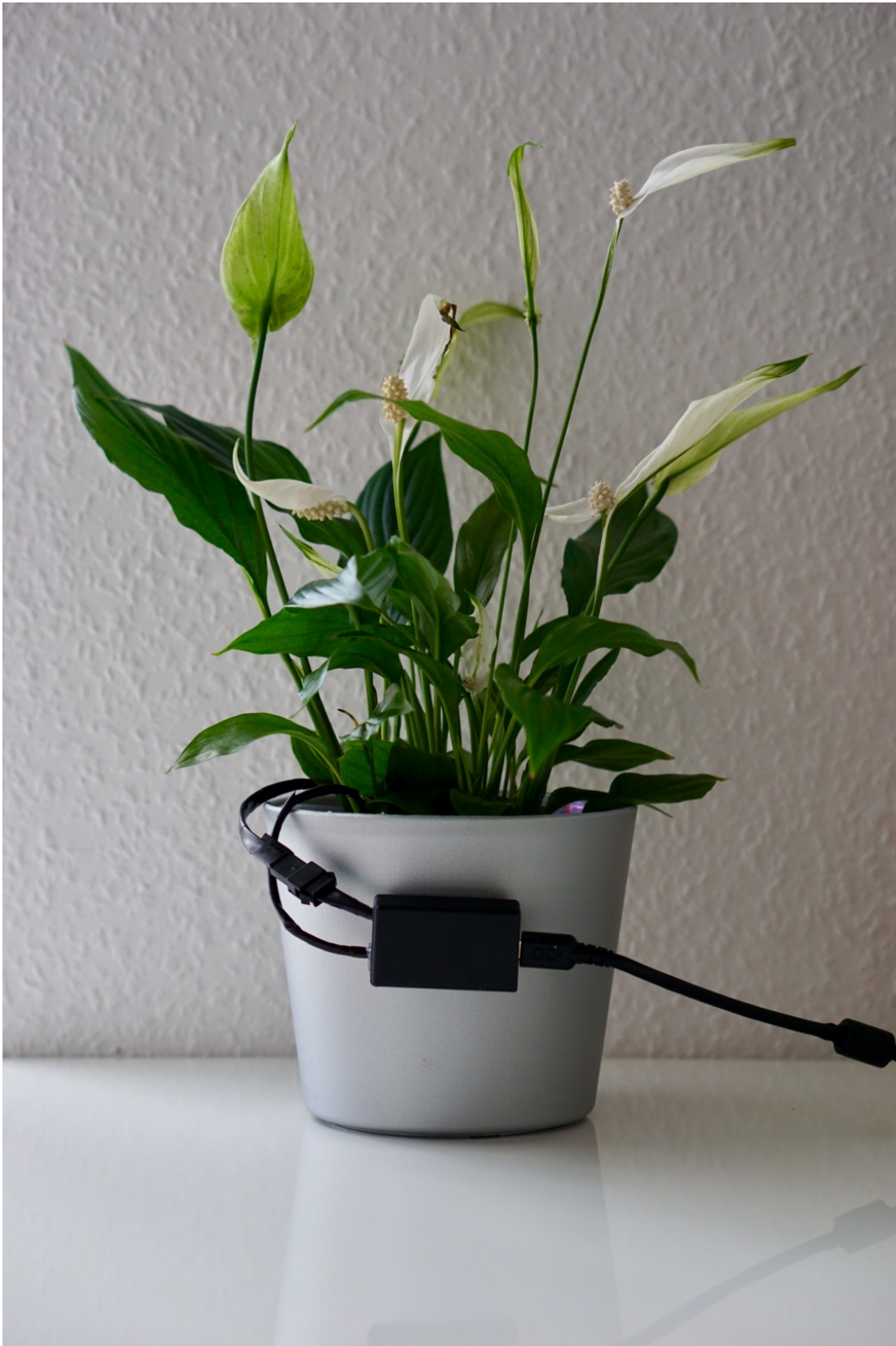
Abbildung 5.2.: Prototyp: Pflanze mit Mikrocontroller (in 3D-gedrucktem, schwarzen Gehäuse) und Sensor. Die Beleuchtung ist ausgeschaltet.
