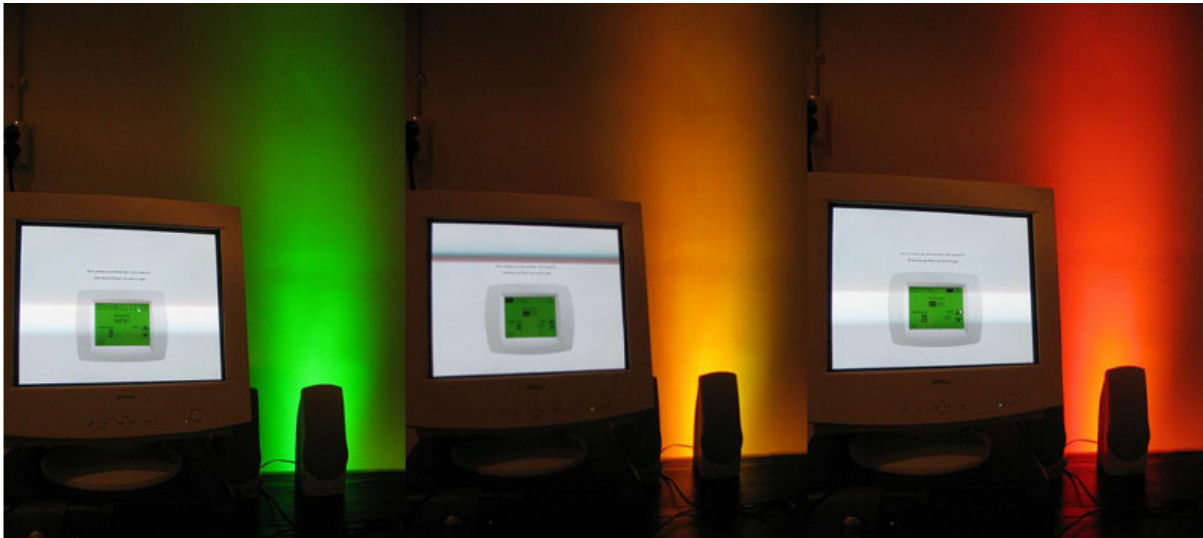
Abbildung 2.2.: Studienaufbau zur Bewertung des Energieverbrauchs [MMHM11]. Wiedergabe der Werte durch LEDs die an die Wand strahlen und einer Wattanzeige, die auf dem Monitor sichtbar ist. Links: Wenig Verbrauch. Mitte: Mittlerer Verbrauch. Rechts: Hoher Verbrauch.
