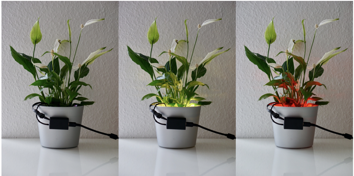
Abbildung 5.5.: Dynamische Darstellung des Zustands an der Pflanze in den Farben Gelb und Rot durch die LEDs im Topf. Links: Die LEDs leuchten nicht: „Die Pflanze ist glücklich.“ Mitte: Die LEDs leuchten gelb: „Die Pflanze braucht demnächst Wasser.“ Rechts: Die LEDs leuchten rot: „Die Pflanze braucht dringend Wasser.“
