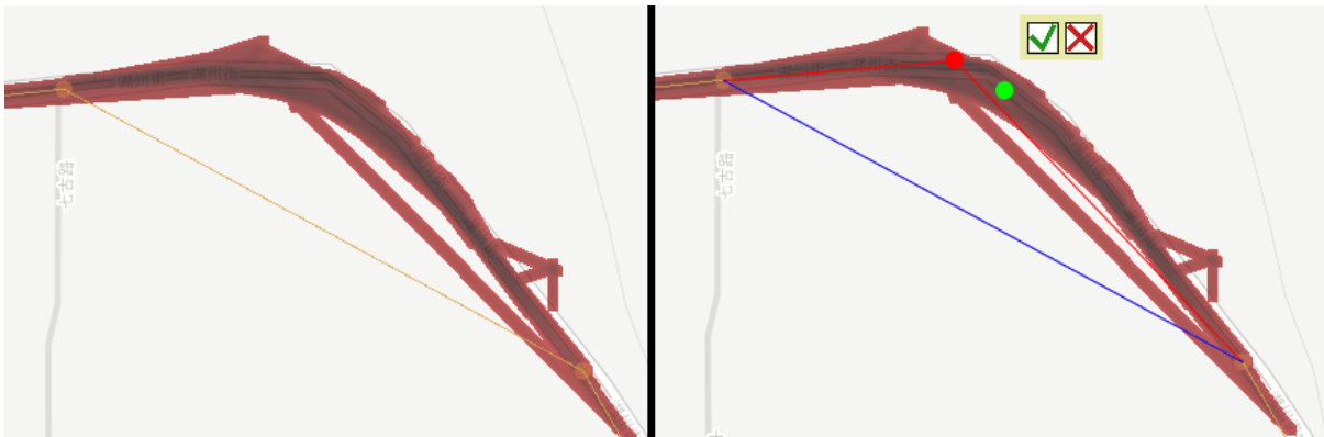
Abbildung 4.6: Vorgeschlagene Korrektur einer Straße. Links: Ursprüngliche Straßenkante (gelb) mit Fehlerdarstellung (rot). Rechts: Vorgeschlagener Verlauf der Straße (hellrot) ersetzt ursprüngliche Kante (blau). Grüner Punkt beschreibt die ausgewählte Fehlerstelle.
