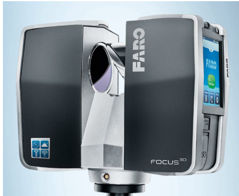
Abbildung 2.1.: FARO® Focus 3D Laserscanner - Der von der Firma FARO® entwickelte Laserscanner Focus 3D , ist über einen Touchscreen bedienbar. Laser und Kamera sind in der linken Hälfte des Gerätes untergebracht.[FAR12]
