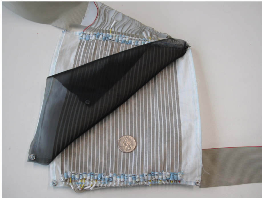
Abbildung 4.3.: Entwickler berührungsempfindlicher Stoff mit Quarter Dollar zur Größeneinschätzung
