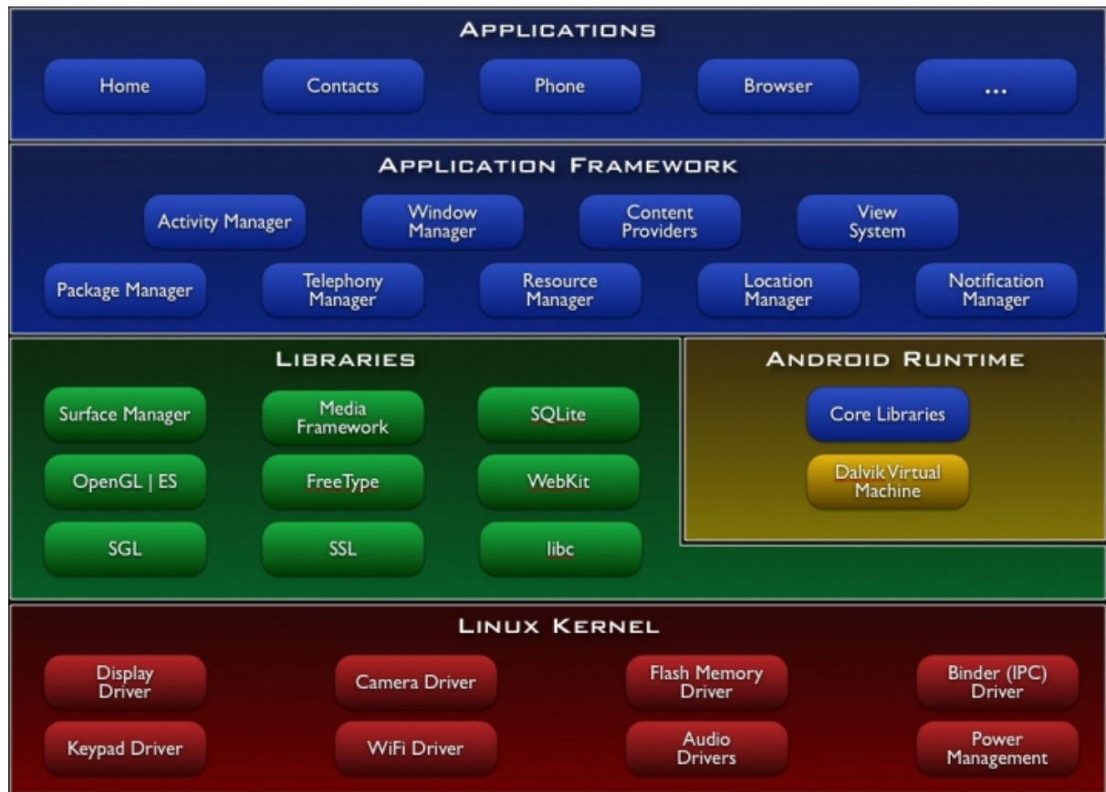
Abbildung 3.3: Aufbau von Android. (Quelle: Documentation for Android SDK)
