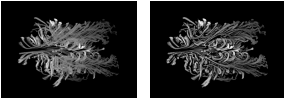
Abbildung 3.2: VolumeLIC mit Abbildung der Geschwindigkeit auf den Alphawert. Links ohne Halo, rechts mit Halo zur Hervorhebung der Tiefeninformationen. (Eigentum von Victoria Interrante) [ http://www-users.cs.umn.edu/~interran/3Dflow.html ]
