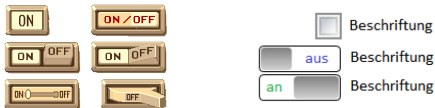
Abbildung 30 Mögliche Ersatzelemente von Kontrollkästchen. Links: Alte GUI-Elemente aus [Plaisant, et al., 1992]. Rechts: Beispielhafte Umsetzung mit WPF als Widgets. Die Bedienung von Kontrollkästchen wurde in der Studie aus Kapitel 8 untersucht.
