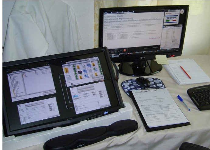
Abbildung 64 Der Aufbau des berührungsempfindlichen Bildschirms für die Benutzerstudie. Hinten rechts kam ein Bildschirm zur Darstellung des aktuellen Aufgabentextes und zur Ablaufkontrolle zum Einsatz. Daneben liegt ein Fragenkatalog, den die Teilnehmer für die Bearbeitung beantworteten.
