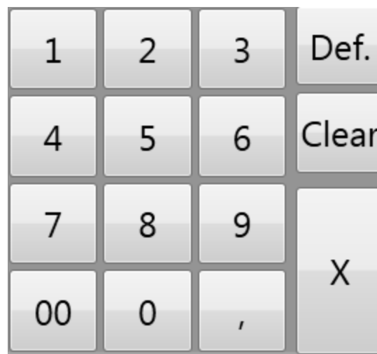
Abbildung 33 Ein Zahlenfeld für die präzise Eingabe von Kommazahlen, das sogenannte numerische Tastenfeld. Die Schaltfläche „Def“ setzt den Wert im Textfeld auf die ursprüngliche Eingabe zurück. „Clear“ belegt die Eingabe mit dem Wert 0. „X“ schließt die Eingabe ab. Die Eingabe wird abgebrochen, indem der Bereich außerhalb des Tastenfeldes berührt wird.
