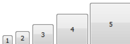
Abbildung 29 Verschiedene Größen von Schaltern: 5, 7, 10, 15 und 20 Millimeter Seitenlänge. Die Größe hat einen Einfluss auf die Bedienung mit den Fingern.
