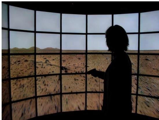
Abbildung 18: Beispiel eines autostereoskopischen Displays(The Varrier) [36]
