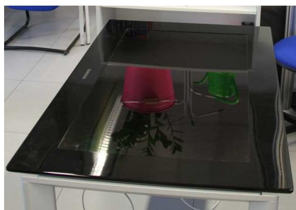
**Abbildung 89: Der Microsoft Pixelsense des VIS**
