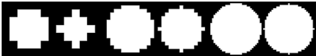
Abb. 11: Kreise mit Radien 2, 6 und 15; links mit Rundung, rechts ohne
