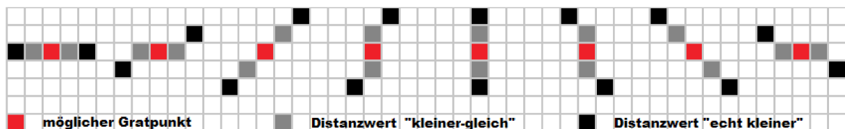
Abb. 17: Alle acht möglichen Richtungen für den Gratlinien-Test
