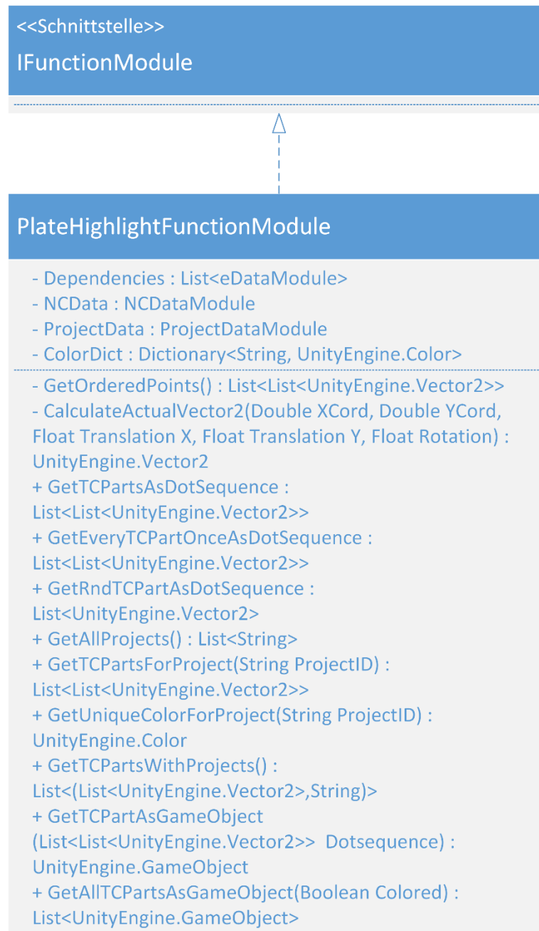
ABBILDUNG 41 - UML KLASSENDIAGRAMM FÜR DAS PLATEHIGHLIGHTFUNCTIONMODULE
