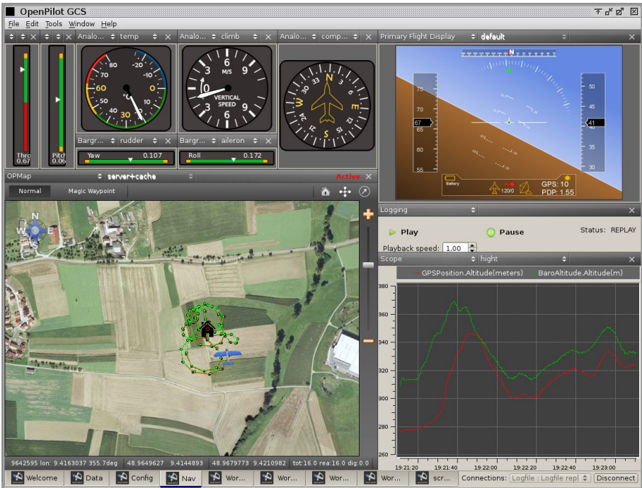
Abbildung 4.19: OpenPilot GCS - Echtzeitvisualisierung der UAV Flugdaten. Die GCS kann live, während eines Fluges, oder beim Abspielen aufgezeichneter Telemetriedaten sämtliche Flugparameter visualisieren. Dabei kommen Anzeigen wie ein künstlicher Horizont, virtuelle Instrumente, aber auch Datenplots und digitale Online-Karten wie Google-Maps zum Einsatz.
