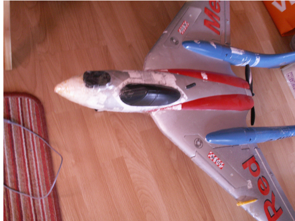
Abbildung 4.30: Kameraabfestigung. Die Kamera zur Videoaufzeichnung wurde auf der Oberseite des Rumpfes angebracht, mit leicht nach unten gerichtetem Blickwinkel. Zur Befestigung diente Tesafilm, der auch zur Fixierung der Komponenten im Rumpf verwendet wurde.
