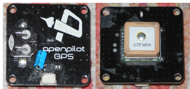
Abbildung 4.5: GPS Modul. Foto der Vor- und Rückseite des OpenPilot beta GPS Moduls. Dieses Modul liefert GPS Daten über eine 3.3V serielle Verbindung im NMEA Standard[67]. An dem Modul waren bedingt durch den beta Status manuelle Modifikationen erforderlich, wie etwa das Hinzufügen eines Kondensators.
