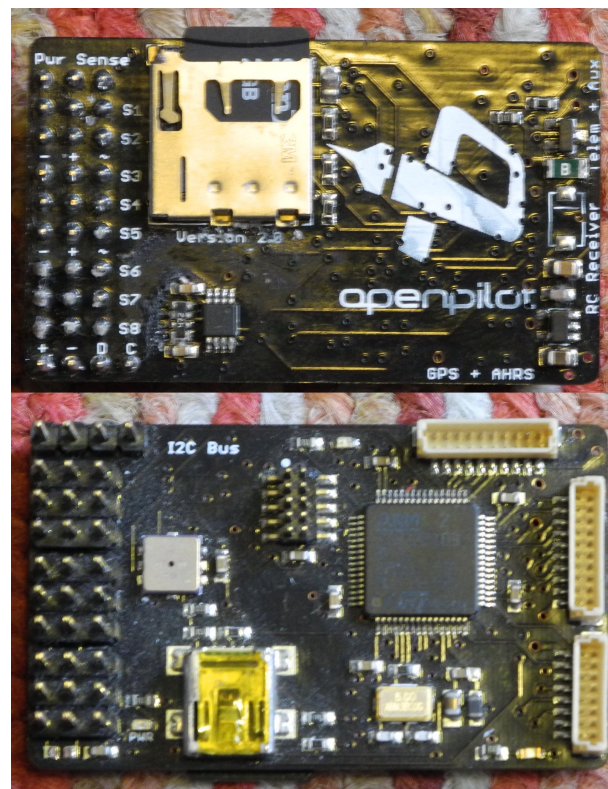
Abbildung 4.7: OpenPilot PRO beta Main Board. Foto der Vor- und Rückseite des OpenPilot beta Mainboards. Dieses Modul ist die zentrale Komponente der OpenPilot Avionik und dient der Verarbeitung aller Daten und der Ein- Ausgabe. Es verfügt über einen Micro-SD Kartenslot und einen Drucksensor vom Typ Bosch Sensortec BMP085[Bos08].
