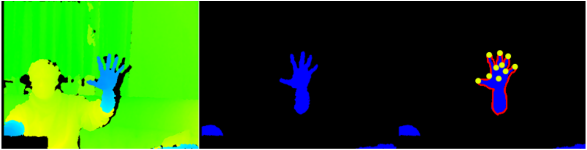
Abbildung 2.3.: Aus Kinect-Tiefendaten extrahierte Hand, mit openCV erkannt
