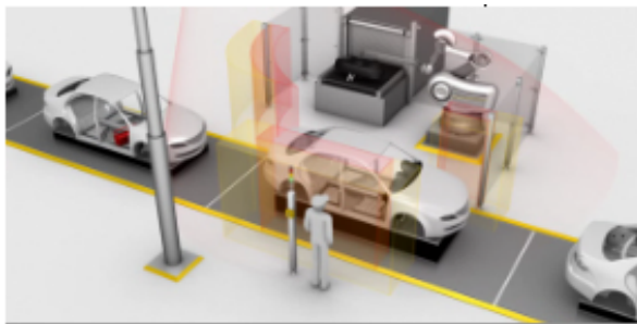
Abbildung 2.4.: Bereichsüberwachung mit Pilz SafetyEYE: Der Roboter fährt einen Bereich nicht an, wenn der Werker sich in diesem Bereich befindet
