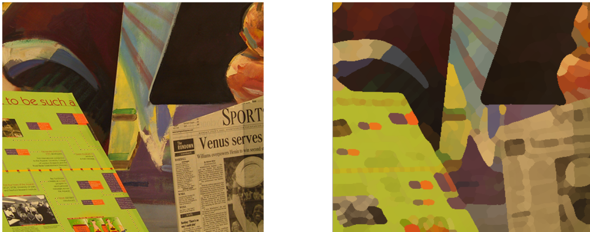
Abbildung 4.1: Links: Zweites Bild der Venus Testsequenz [SS02], Rechts: Segmentiertes bild mit \sigma = 4 .
