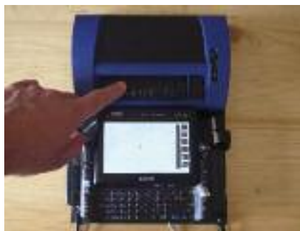
Abb. 10: Die Kombination von TANIA mit einer ATC-Braillezeile ermöglicht das schnelle Lesen von längeren Texten auch für Taubblinde, da beim letzten Braille-Buchstaben automatisch gescrollt wird.
