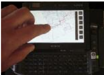
Abb. 6: Das TANIA-System (Tactile-Acoustical Navigation and Information Assistant) ermöglicht virtuelle Erkundungen von Karten und eine reale Navigationsunterstützung mit Schrittgenauigkeit.
