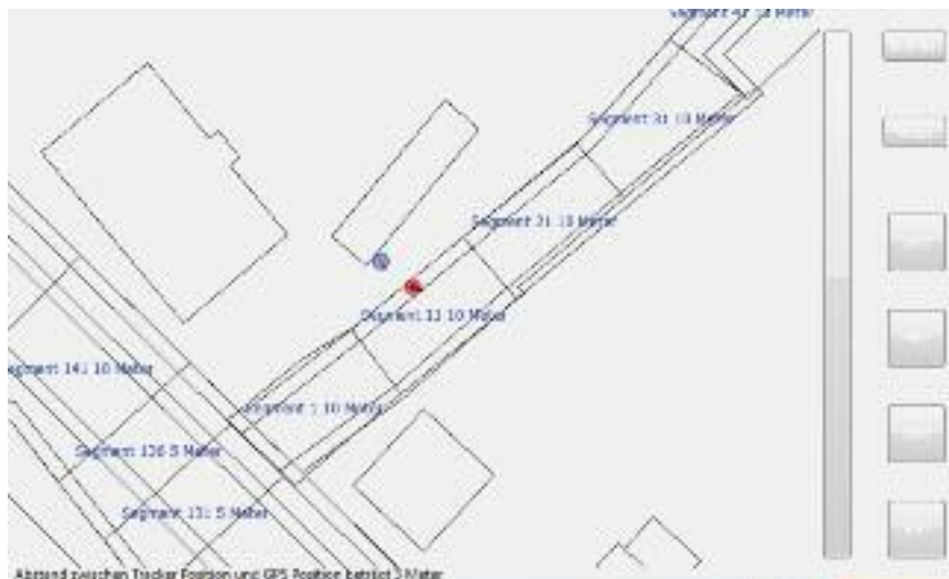
Abb. 11: Screenshot der TANIA-Oberfläche mit Karte, Maßstabstaste mit akustischer Ausgabe (vertikale Linie), Softkeys (rechte Seite) und den aktuellen Positionen, die über GPS (blauer Kreis) und das entwickelte Trackingverfahren bestimmt werden (roter Kreis). Auf Tastendruck können diese Positionen einmalig oder periodisch synchronisiert werden.
