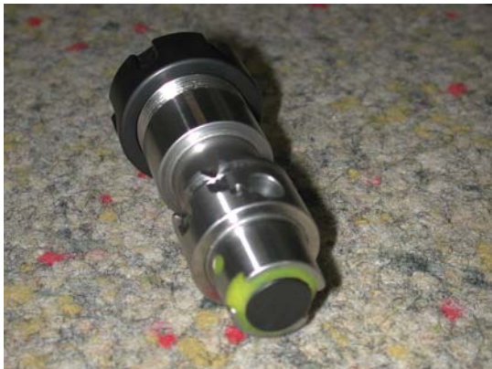
In Werkzeugaufnahme integrierter RFID Chip
