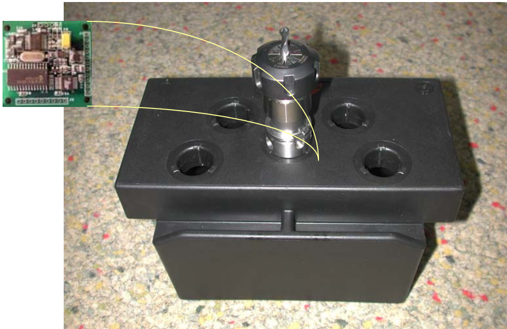
Intelligente Objekte in der Produktion ( Werkzeughalter )
