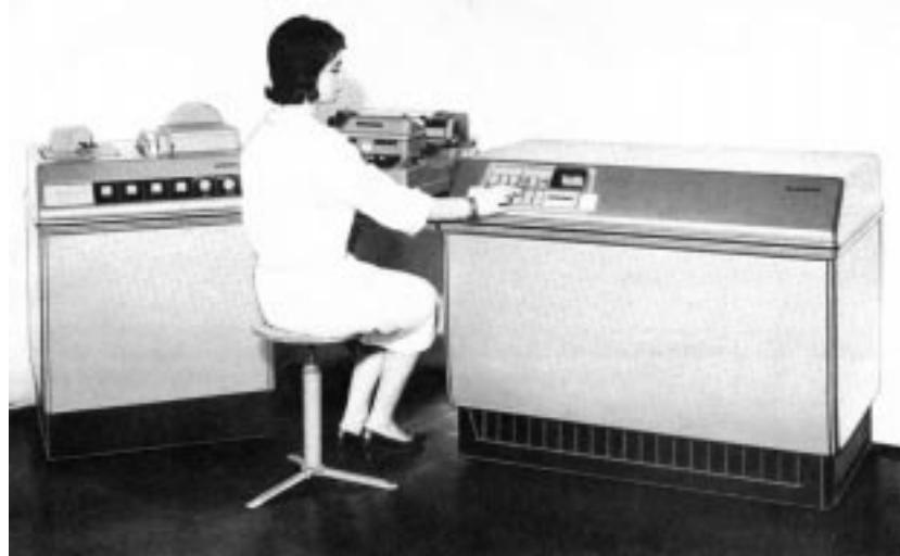
Interessanter Neuzugang des vergangenen Jahres: Ein LGP-30, ein röhrenbestückter Magnettrommelrechner der ersten Generation aus dem Jahr 1958. Rechts im Bild die CPU, links der Lochstreifenleser/ Stanzer. Aus einer zweiten Quelle kam ein großer Softwarefundus für diesen Rechner.
