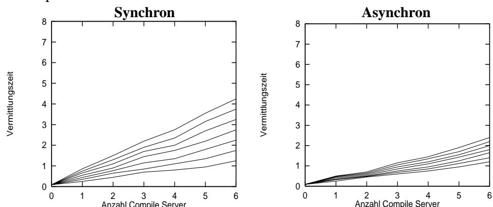
In diesem Beispiel wurden für die eingesetzten dynamische Attribute sinnvolle, aber unterschiedliche Aktualitätsprädikate gesetzt. Da es bei Aktualitätsprädikaten auch auf die Frequenz der Zugriffe ankommt, damit der Cache gefüllt ist, wurde vor den Messungen erst eine Einschwingphase vorneangestellt, die den Cache gut füllt.
