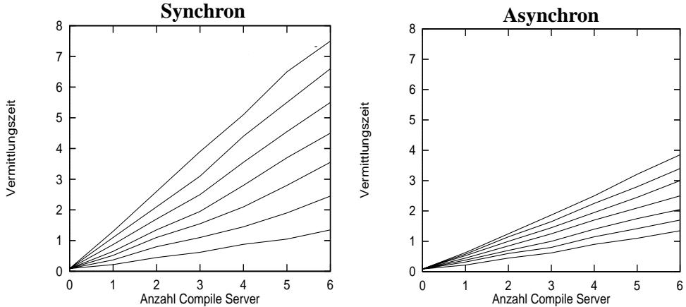
Unterschiedliche Linien in dem Diagramm zeigen eine steigende Anzahl von dynamischen Parametern. Der asynchrone Zugriff führt zu einer deutlichen Verbesserung der Vermittlungszeiten. Wie zu erwarten bleibt der Aufwand bei nur einem dynamischen Attribut gleich.
