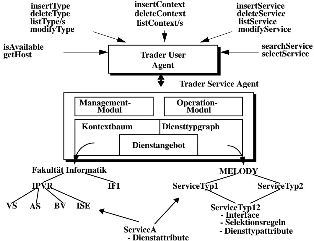
Der TUA bietet die Operationen des Traders einem Tradernutzer (Klient, Server oder Systemmanager) an und wird zu einem entsprechenden Programm hinzugelinkt. Es existieren ein grafisches und ein textbasiertes Interface, mit dem die entsprechenden Traderoperationen direkt aufgerufen werden können.
