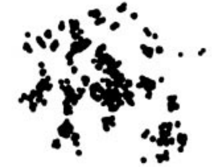
Abb. 8.9: Öffnung mit größerem Strukturelement
