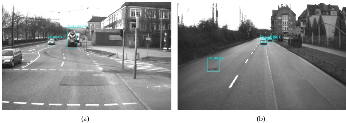
Abbildung 6.14.: Typische Szenen beim Einsatz des Gesamtsystems. Zum Einsatz kam der 4000-er DB-CBT. (a) Unterschiedliche Objektfenster für LKW und PKW. (b) Korrekt detektierte PKW zusammen mit einem Falschalarm.
