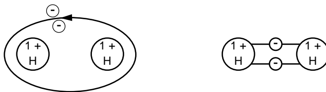
Bild 4.2: Valenzbindung des Wasserstoffmoleküls \text{H}_2 links: Atommodell; rechts: schematische Darstellung
